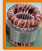
Dağınkı tip motor sargısı
